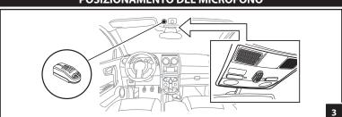
La posizione del microfono è fondamentale ai fini di un corretto funzionamento del sistema. Si consiglia di installare il microfono in prossimità della plafoniera centrale. Si sconsiglia invece di applicare il microfono direttamente sul parabrezza in quanto i disturbi dovuti al fruscio del vento potrebbero rendere difficoltosa la conversazione.
